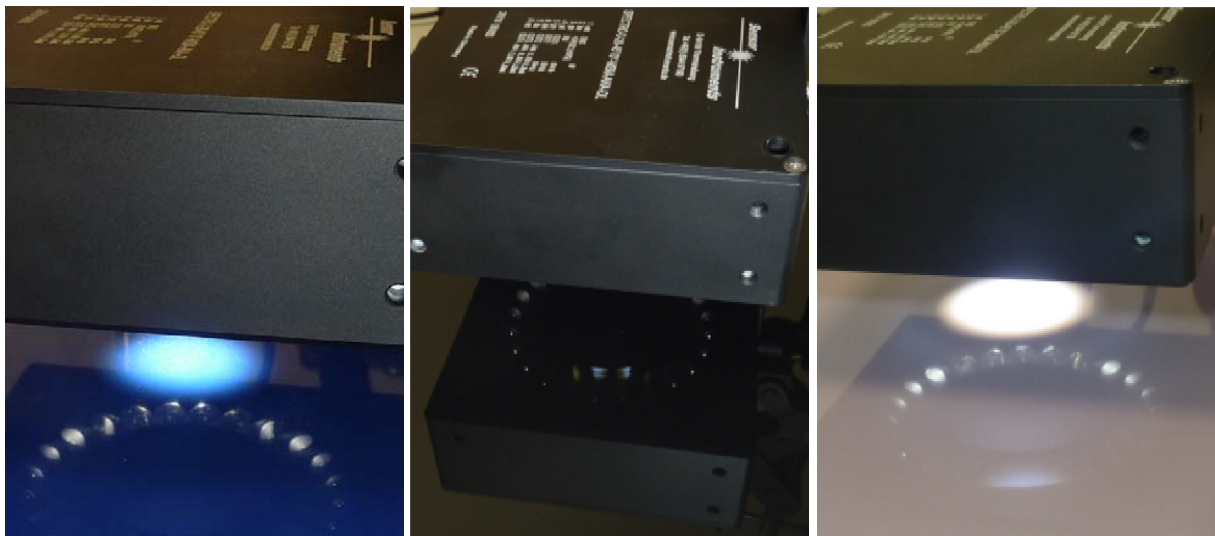
Mesure de la couleur sur des plaques métalliques immédiatement après le processus de revêtement avec le SPECTRO-3-28-45°/0°-MSM-ANA-DL
